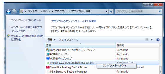
図 2. 古い Anaconda のアンインストール。「プログラムと機能」から Python 3.6... を選択する。
