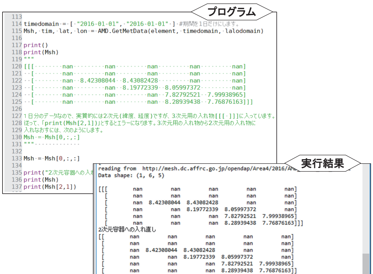
図 IV-3. サンプルプログラム sample_GetMetData-a.py の 113 行～ 137 行目 (左上) と対応する実行結果 (右下)
